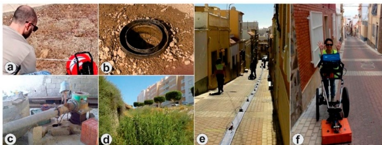
Figura 3. (a) Medida piezométrica en un sondeo en el Pago del Lugar durante la campaña hidrogeológica de junio de 2015. (b) Ensayo de infiltración mediante la técnica de doble anillo realizado en la calle Cerca durante la campaña hidrogeológica de marzo de 2010. (c) Ensayo de bombeo en un pozo en el Pago del Lugar durante la campaña hidrogeológica de septiembre de 2014. (d) Vista general del manantial “Mina de Carreño” en la calle Portón durante la campaña hidrogeológica de marzo de 2010. (e) Implementación del ensayo MASW M4 en la calle La Unión durante la campaña geofísica de febrero de 2014. (f) Implementación del ensayo GPR G4 en la calle La Unión durante la campaña geofísica de junio de 2015.
